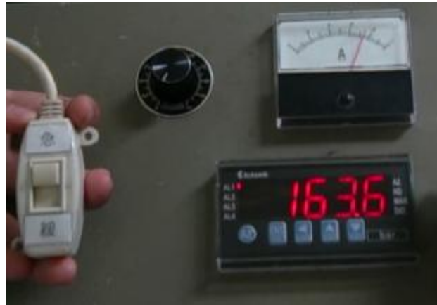
圖 24 煞車(急煞)時的實測電流大小值
