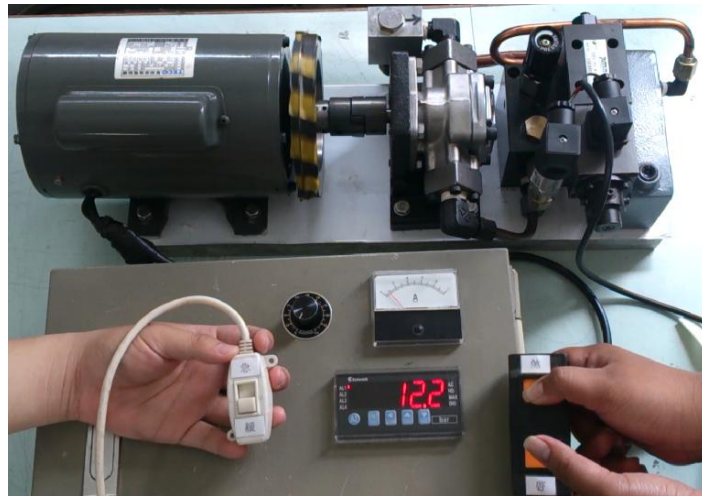
圖 21 煞車(緩煞)時的管壁壓力值
