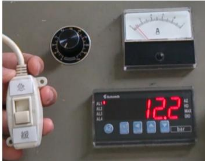
圖 22 煞車(緩煞)時的實測電流大小值
