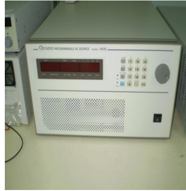
Fig 14. Chroma 交流電源供應器 190-250V 47-63HZ 20A 5KW
