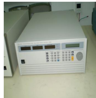
Fig 12. Chroma 電子負載 5A/50A 125V/500V 2.6KW
