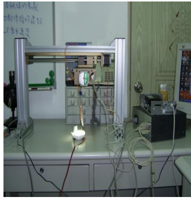
圖四、全電式電動車參加競賽情形 圖五、液晶面板之輝度量測系統
