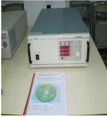
Fig 13. 高階交流電源供應器(5KVA)
