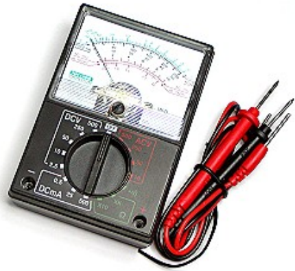
三用電表VAC檔 量測電壓
