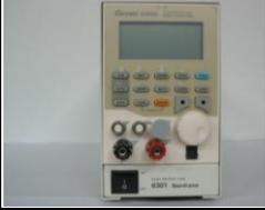
電子負載    | 8 台           | 95.9     | ✓      |        |        | 切換式電源供應器實驗            |
