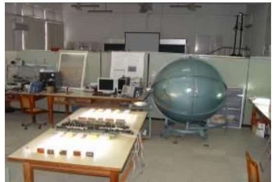
冷陰極燈管光電特性監測
